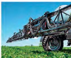
Штанги ProAcrion-Flex с захватом от 27 до 36 м. и автоматическим контролем высоты обработки. Эффективная 3D-система стабилизации с элементами Henschel и уникальными демпферами гарантирует точное и равномерное внесение препаратов.
