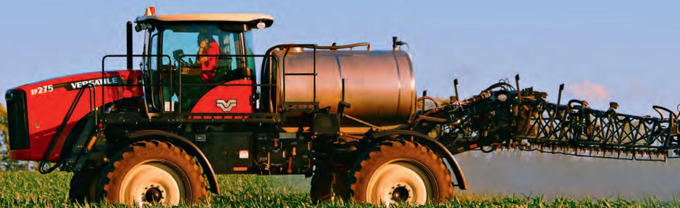
**Опрыскиватель VERSATILE SP 275** — эффективная и мощная, экономичная и высокопроизводительная машина, созданная с учётом всех тонкостей обработки сельскохозяйственных культур в реальных условиях способна обрабатывать 1 200 гектаров в сутки. Опрыскиватели Versatile вносят все типы препаратов с расходом рабочей жидкости от 50 до 500 литров на гектар. Эта машина по праву является одним из самых выгодных предложений на рынке.
