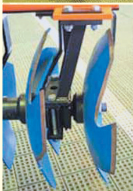
БДТ-3,8 - агрегатирование с тракторами класса 3 мощностью 185-200 л.с.
